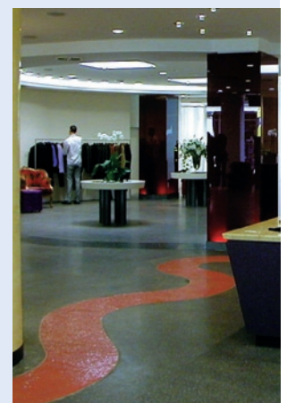
bitu-Terrazzo® mit Fußbodenheizung als direkt genutzter, geschliffener Gussasphalt-Heizstrich für ganz unterschiedliche Anwendungen
