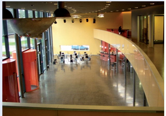
Zwei Baustoffe, ein System: geschliffener Gussasphalt-Heizestrich mit hartgelöteten Kupferrohrleitungen in der Aula einer Fachhochschule
